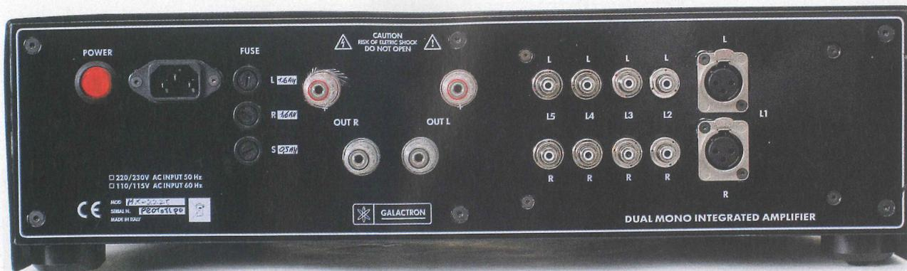
Il pannello posteriore dove notiamo i connettori per i cavi di potenza che sono montati in posizione sfalsata, il che ne rende comoda l'utilizzazione, e al pari di quelli di segnale sono realizzati in metallo rodato di eccellente qualità.
